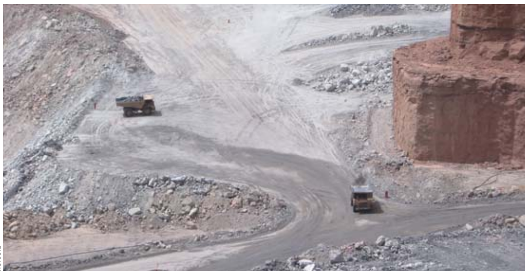
Mine à ciel ouvert de Somair, à Arlit au Niger. Les méthodes d'autorembayage (verse sous le camion à gauche) permettent une meilleure économie de l'exploitation et aident à limiter l'impact paysager et environnemental, mais rendent quasi impossible la récupération ultérieure de zones minéralisées abandonnées en fond de fosse ou de "stériles" à basse teneur.
